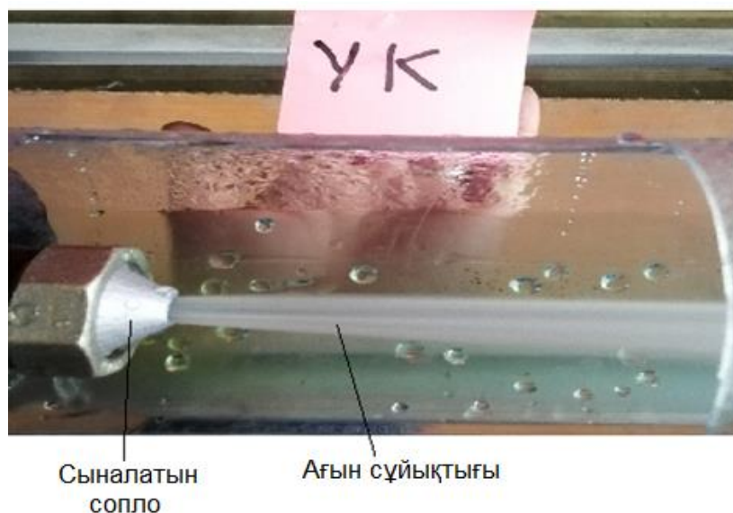
3.6 Сурет – Сыналатын соплодан шығып жатқан жоғары жылдамдықты сұйықтық ағынының формасы
