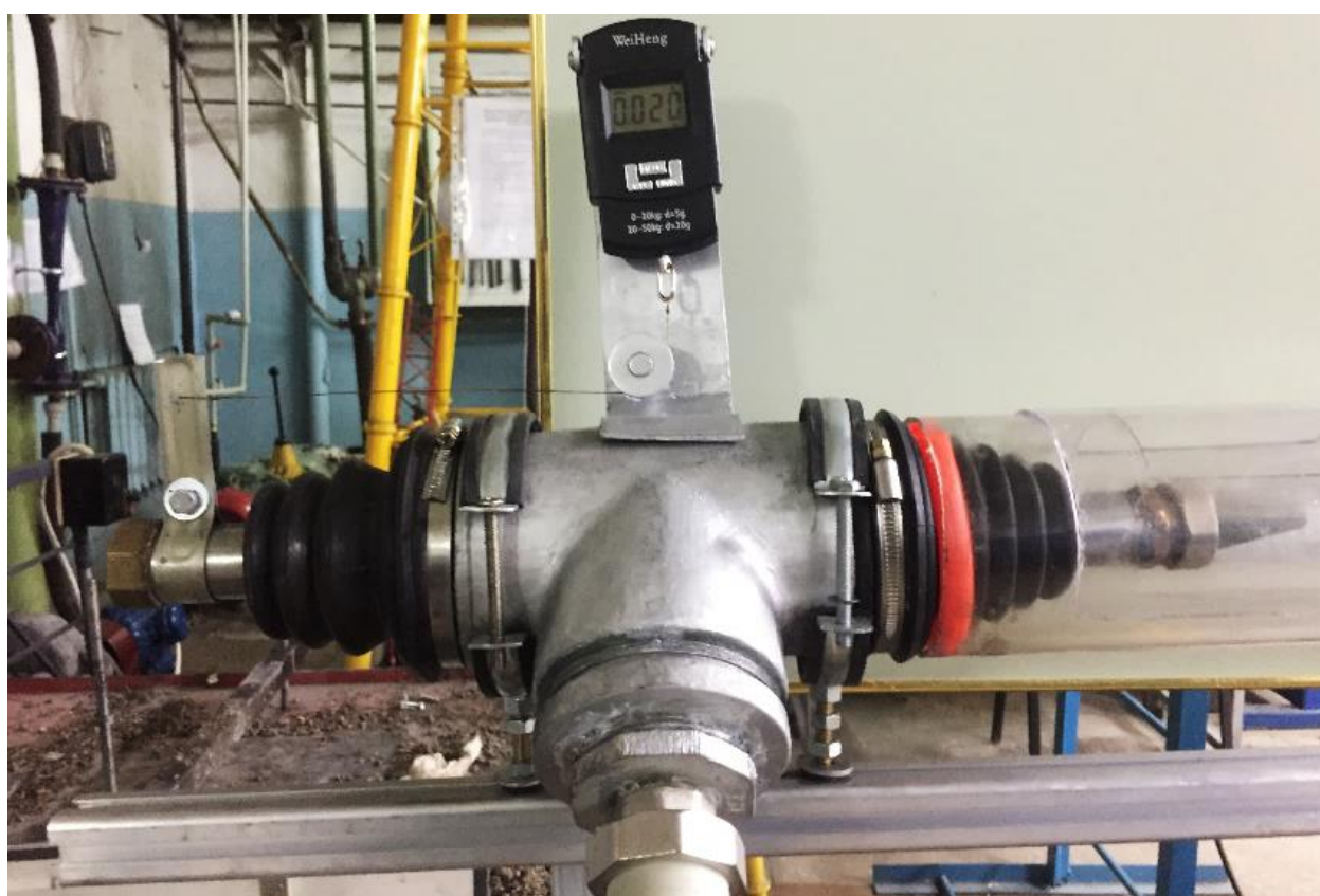
1 – тройник; 2 – гофра; 3 – тегеурінді құбыр; 4 – кронштейні бар бітеуіш; 5 – ілмекті гайка; 6 – шүмек; 7 – кронштейн; 8 – күш өлшегіш; 9 – трос
