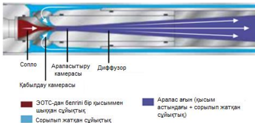
1.3 Сурет – Ағынды аппараттың принципіалды схемасы
